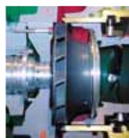
Небольшое количество жидкого хладагента впрыскивается в область нагнетания компрессора. Капли поглощают энергию звука и уменьшают общий рабочий уровень шума компрессора. Капли испаряются и уменьшают перегрев на нагнетании.
