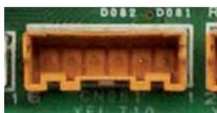
Внутренний блок ECOi легко подключается к внешнему устройству. Разъём T10, установленный на электронной плате всех внутренних блоков, позволяет осуществлять цифровое подключение к внешним устройствам.
