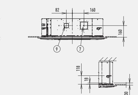
Отрегулируйте длину подвесного болта так, чтобы зазор от нижней поверхности потолка составлял 30 мм или более (18 мм или более от нижней поверхности блока), как показано на рисунке. Длинный подвесной болт будет упираться в потолочные панели, в этом случае установка будет невозможна.
