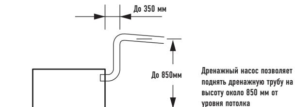
Дренажный насос позволяет поднять дренажную трубу на высоту около 850 мм от уровня потолка
