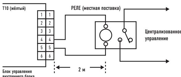
Примечание: Длина проводки от внутреннего блока до реле не должна превышать 2,0 м. Импульсный сигнал меняется на статический с помощью перемычки. (См. JP001)
