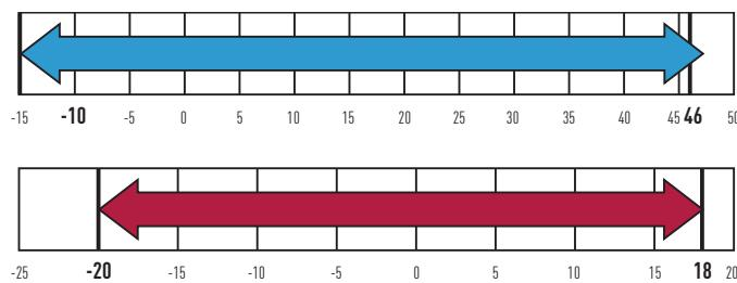
Охлаждение:  $-10^{\circ}\text{C}$  DB -  $46^{\circ}\text{C}$  DB / Обогрев:  $-20-18$  (WB)
