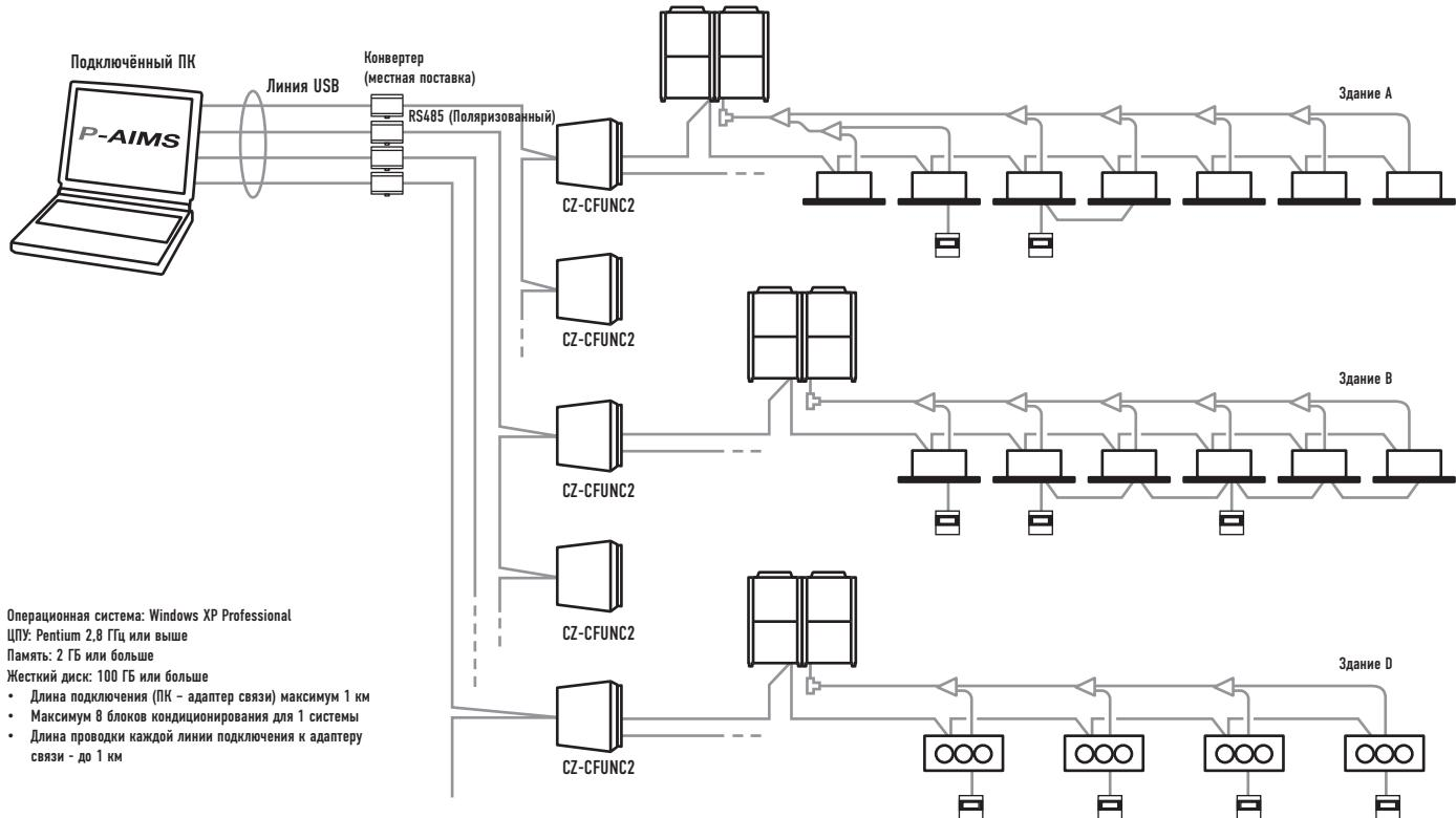
**Дополнительное программное обеспечение P-AIMS CZ-CSWAC2, предназначенное для распределения нагрузки**
