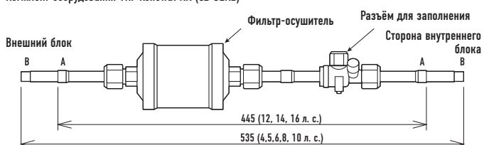
Размеры подключаемых трубопроводов (дюйм (мм)): А 1 / 2 (12.7) (12, 14, 16 л. с.) - В 3 / 8 (9.52) (4, 5, 6, 8 и 10 л. с.)
