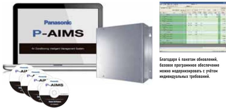
P-AIMS подходит для крупных торговых центров и университетов с большим количеством площадей / зданий. 1 На компьютере "P-AIMS" может быть установлено до 4 независимых систем одновременно. Каждая система может иметь максимум 8 блоков кондиционирования воздуха, и управлять максимум 512 блоками. В общей сложности, один компьютер "P-AIMS" может управлять до 1024 внутренних блоков.
