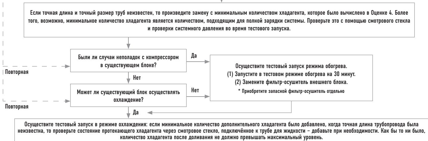
Оуществите тестовый запуск в режиме охлаждения: если минимальное количество дополнительного хладагента было добавлено, когда точная длина трубопровода была неизвестна, то проверьте состояние протекающего хладагента через смотровое стекло, подключённое к трубе для жидкости – добавьте при необходимости. Как бы то ни было, количество хладагента после долива не должно превышать максимальный уровень.
