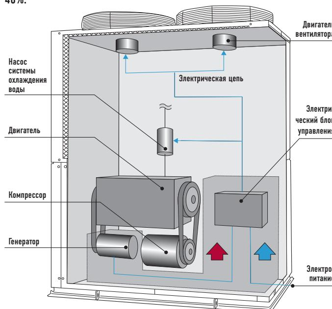
**Газоприводной тепловой насос (GHP) с электрическим генератором.**
