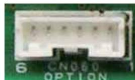
**PAW-OCT:** Panasonic разработал дополнительное оборудование, поставляемое по желанию заказчика, (состоящее из штекера и проводов) под название PAW-OCT для простого подключения к разъему (CN060).
