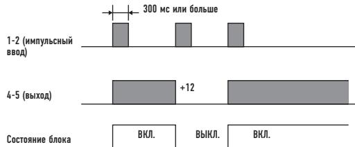
ПРИМЕЧАНИЕ: длина проводки от внутреннего блока до реле не должна превышать 2,0 м. Импульсный сигнал меняется на статический с помощью перемычки. (См. JP001)
