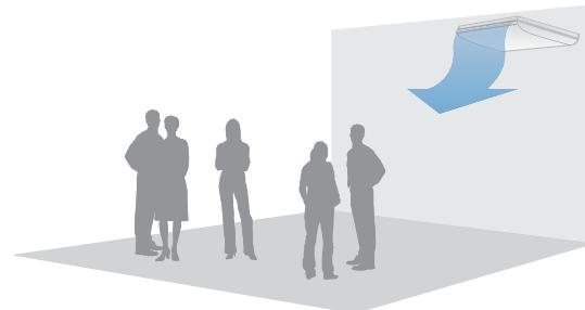
Распределение воздуха автоматически изменяется в зависимости от режима работы блока
