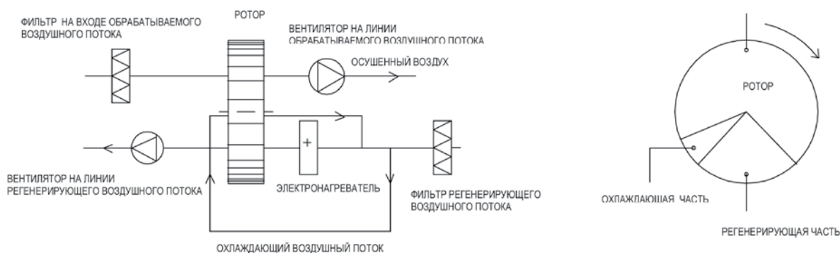
Принципиальная схема осушителей CR1500 – CR2500
