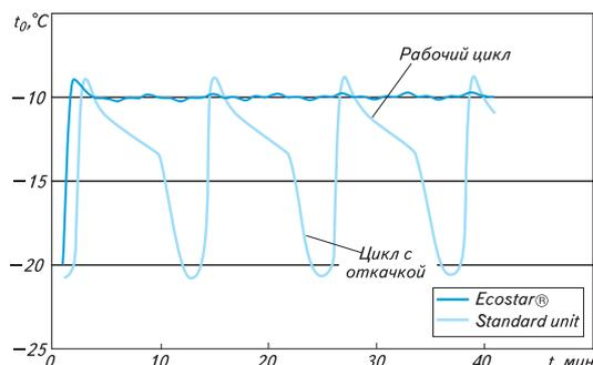
Давление всасывания агрегата Ecostar® оптимизировано путем регулирования частоты вращения вала компрессора.
