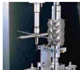
Оборудование «Medium 3D» для изготовления роторов винтовых компрессоров
