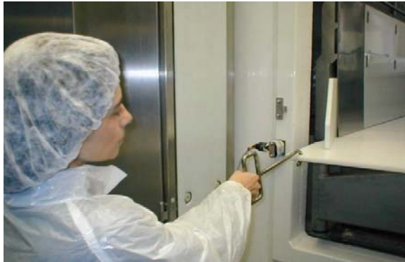
Пластины ОктоФроста™ могут быть легко удалены и помыты снаружи туннеля.
