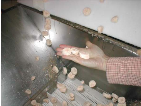
Дольки банана на выходе. Нам удается заморозить на ОктоФрост™ дольки банана с уровнем BRIX 23 и температурой на входе +23° С без комков или с очень низким образованием комков.
